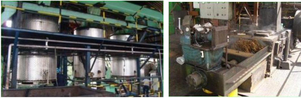
Fig 15: Màquines on es realitza la digestió i el premsat del fruit.
