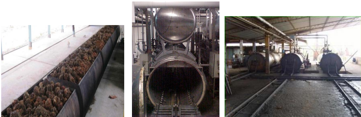
Fig 13: Màquines d'esterelització on s'introdueixen els contenidors amb les pinyes.
